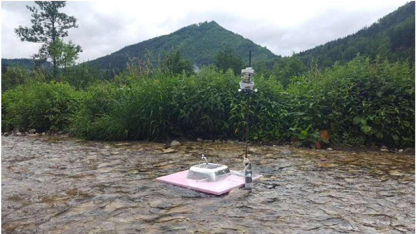
Freiland, Mesokosmos, Labor: Die Kombination macht's! Mit dieser speziellen Kammer messen die Forscher*innen die CO 2 -Konzentration im Oberen Seebach in Lunz. © Katrin Attermeyer
